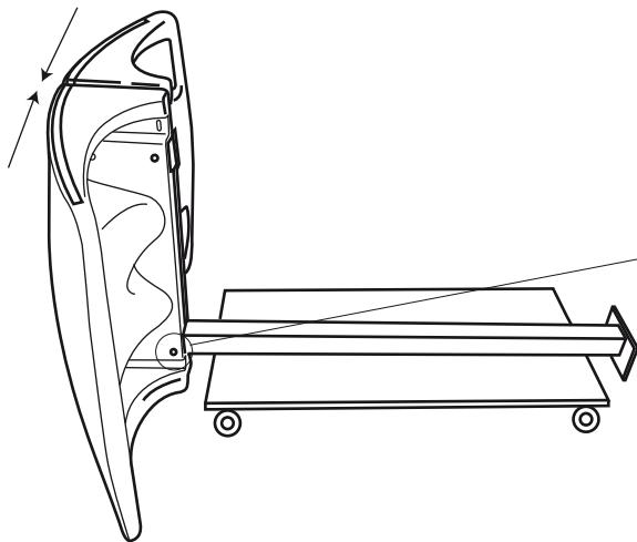
2. Positionieren Sie die erste Überdachung auf die Seite, auf eine angehobenen Fläche und platzieren Sie den Pfosten in die Vertiefung auf der Rückseite der Überdachung.
