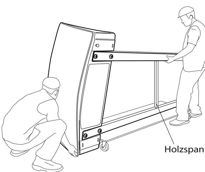
**10.** Heben Sie die Überdachung vorsichtig an, durch diese nach oben zu kippen, so dass einer der Pfosten auf dem Boden, wo er verankert werden sollte, steht.
