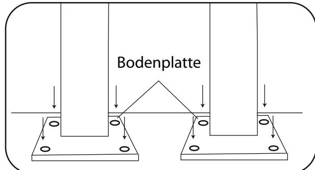
**1.** Bestimmen Sie zuerst, wo Ihre Überdachung aufgestellt werden sollte. Markieren Sie auf dem Boden mit einem Stift die 8 Befestigungslöcher, durch die Bodenplatte als Muster zu benutzen.
