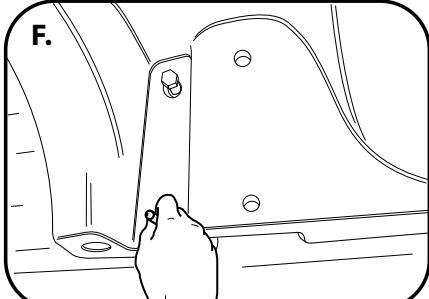
5. Markieren Sie mit einem Stift die 3 restlichen Befestigungspunkte der Überdachung auf die Wand (Abbildung F). Die Position der Befestigungspunkte wird durch die Pfeile über und unter den Befestigungsschlitzten in den Vertiefungen im hinteren Teil der Überdachung angezeigt. Entfernen Sie die Überdachung vorsichtig von dem Bolzen und platzieren Sie die Überdachung auf dem Boden.
