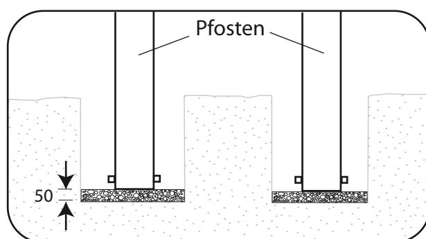
**4.** Stellen Sie sicher, dass die Überdachungen waagerecht eben sind und dass die Pfosten senkrecht zum Boden sind. Um sicher zu stellen, dass die Überdachungen wagerecht eben bleiben, empfehlen wir, dass Keile oder ein Stabilisierungsrahmen genutzt wird, um die Pfosten vor dem Einbetonieren sicher in den Löchern zu halten.
