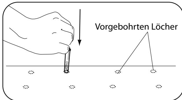
**3.** Stecken Sie die 60mm Dübel in die vorgebohrten Löcher ein und hammern Sie diese sanft runter, bis Sie mit dem Boden bündig sind.
