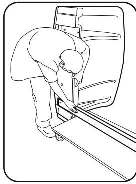
1. Bringen Sie als erstes das Schaumdichtungsstreifen in der Vertiefung auf der Rückseite von jeder Überdachung an, wie hier oben angezeigt.
