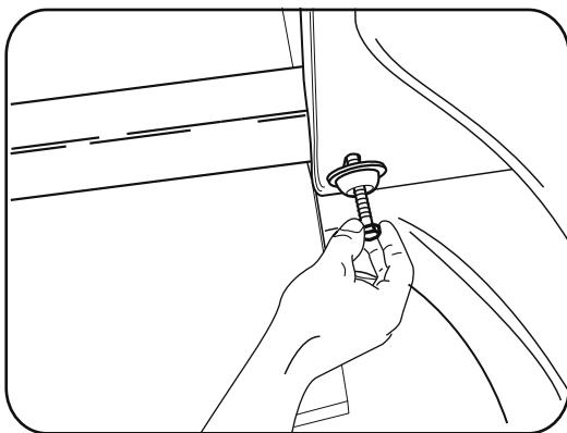
**3.** Setzen Sie die zusammengebaute Fixierung durch das Loch in der Überdachung, bis sie von der anderen Seite des Pfosten aus herausstreckt.
