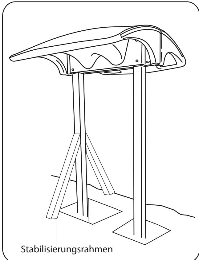
**3.** Füllen Sie die Löcher mit Schotter oder ähnliches Material (ungefähr 50mm) und positionieren Sie dann die Pfosten, woran die Überdachung befestigt ist, in die Löcher.
