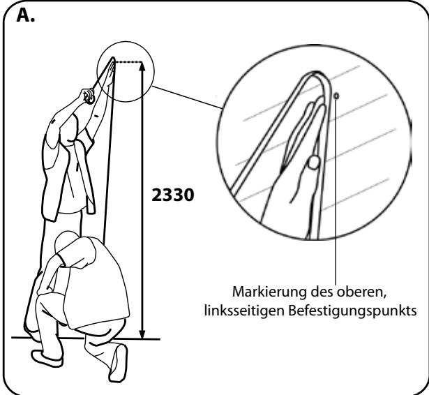
1. Bestimmen Sie zuerst die Position, an der Ihre Überdachung befestigt werden soll. Für die Befestigung Ihrer Überdachung empfehlen wir, mit dem oberen, linksseitigen Befestigungspunkt der Überdachung zu beginnen. Vom Boden her markieren Sie mit einem Stift die Position dieses Befestigungspunkts zu einer Höhe von etwa 2.330mm (Abbildung A).
