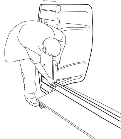
**1.** Platzieren Sie eine der Pfosten auf eine angehobene Fläche, ca. 100mm über dem Boden. Benutzen Sie dafür vorzugsweise einen Transportwagen, so dass die Überdachung mit den zwei Pfosten leicht umzustellen sind, wann sie mit einander zusammengebaut worden sind.
