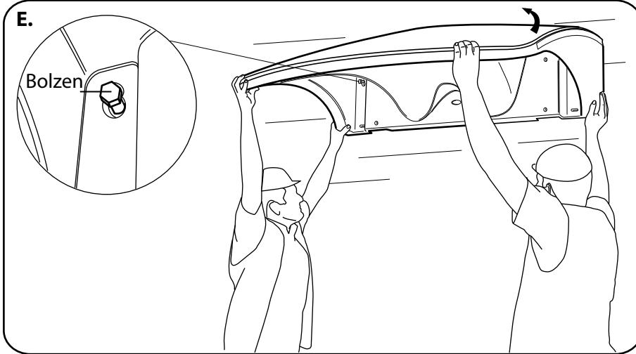
4. Heben Sie die Überdachung ab und platzieren Sie die Überdachung an der Wand, durch den oberen, linksseitigen Befestigungspunkt an den von der Wand herausstreckenden Bolzen anzuhängen. Stellen Sie sicher, dass die Überdachung eben und bündig mit der Wand ist (Abbildung E). Benutzen Sie nötigenfalls eine Wasserwaage.
