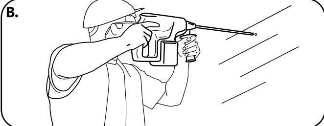
2. Mithilfe eines Bohrhammers und eines Bohreinsatzes mit einem 12mm Durchmesser bohren Sie ein 110mm tiefes Loch durch die markierte Position (Abbildung B).
