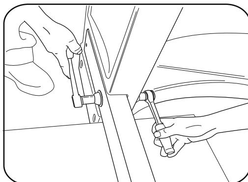
**5.** Mithilfe eines 17mm Drehmomentschlüssels ziehen Sie die Fixierung fest, bis die Überdachung an dem Pfosten sicher und fest befestigt ist.
