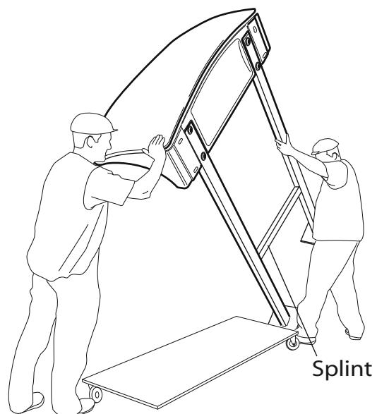
**11.** Sobald die Überdachung aufrecht steht, stellen Sie sicher, dass die Pfosten perfekt senkrecht zu dem Boden sind. Stellen Sie die Pfosten richtig ein, falls
