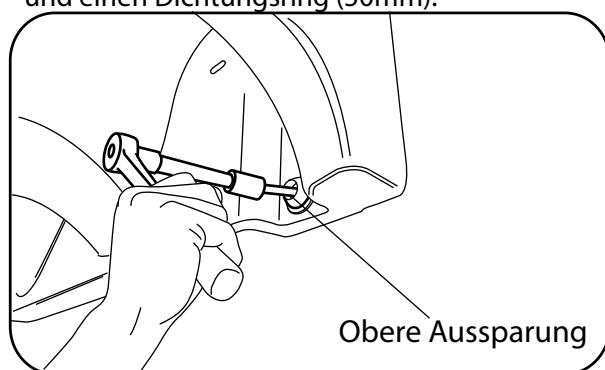
**10.** Heben Sie mit Hilfe der richtigen Hebetechnik und dem richtigen Werkzeug, die Überdachung an, um die 4 Befestigungsaussparungen an die Verankerungspositionen anzupassen. Setzen Sie die Bolzen vorsichtig wieder durch die Befestigungsaussparungen, so dass sie nicht die Verankerungen oder die Bolzen blockieren. Ziehen Sie die Bolzen mit Hilfe eines 17mm Schraubenziehers.
