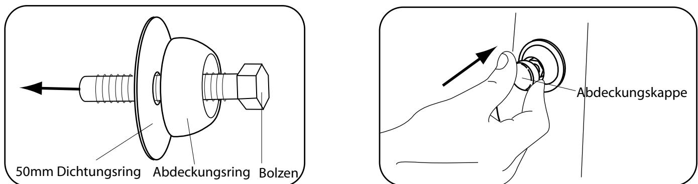
**9.** Wann alle Fixierungen in der Wand eingesteckt worden sind, platzieren Sie jetzt einen Bolzen durch einen Abdeckungsring und einen Dichtungsring (50mm).
