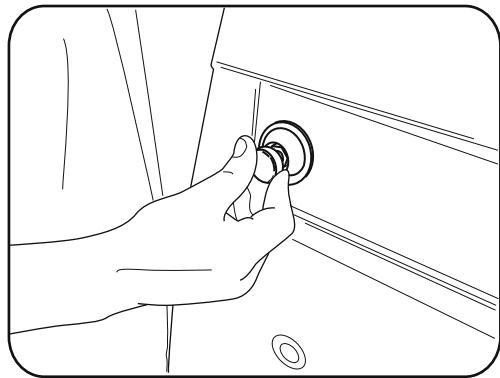
**9.** Zum Schluss, drücken Sie die Abdeckungskappe in die Abdeckungsringe, um die Befestigungen zu sichern.
