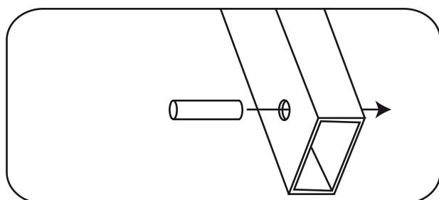
**2.** Fügen Sie die Querstange durch das Loch im unteren Teil von beiden Pfosten. Die Querstange hält die einbetonierte Pfosten im Beton sicher verankert.
