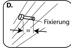
3. Entfernen Sie den Dichtungsring von einer der Fixierungen und hammern Sie die Fixierung in das gebohrte Loch. Stellen Sie sicher, dass die Fixierung völlig eingesteckt ist (Abbildung C). Ziehen Sie die Fixierung mithilfe eines Imbusschlüssels von 17mm fest. Wann die Fixierung sicher festgezogen worden ist, schrauben Sie den Bolzen ab, so dass er von der Wand aus etwa 30mm herausstreckt (Abbildung D).
