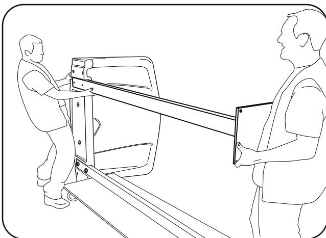
**7.** Heben Sie den zweiten Pfosten an und positionieren Sie ihn in die Vertiefungen an der Rückseite der Überdachung.
