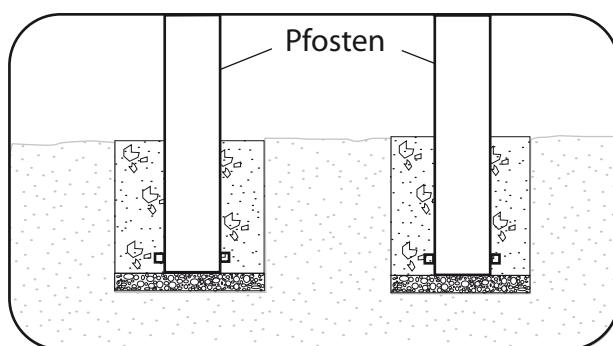
**5.** Gießen Sie Beton in die Löcher bis zur Bodenoberfläche. Warten Sie, bis der Beton völlig hart geworden ist, um die Installation zu beenden und den Stabilisierungsrahmen zu entfernen.
