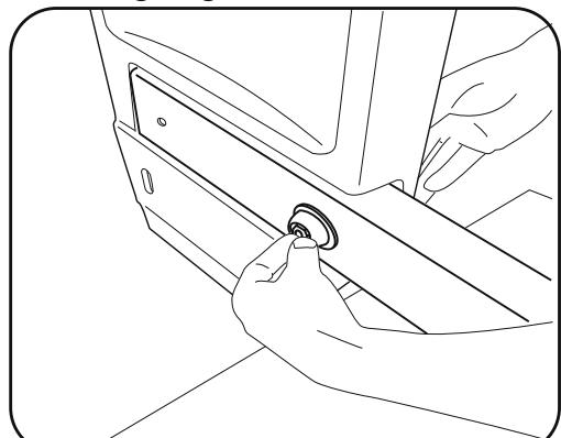
**4.** Platzieren Sie einen 50mm Dichtungsring und eine Abdeckungskappe über den Bolzen und sicher Sie es mit einer Nyloc-Mutter.
