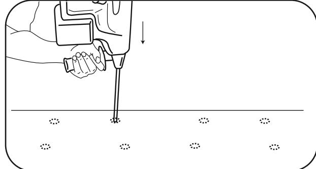
**2.** Entfernen Sie die Überdachung von dem Installationsstandort und bohren Sie mithilfe eines 10mm für Mauerwerk geeigneten Bohreinsatzes die markierten Löcher zu einer Tiefe von 80mm. Entfernen Sie Schutt und Staub von den Löchern und der umliegenden Zone.
