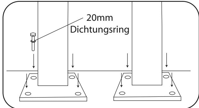
**4.** Platzieren Sie die Überdachung wieder in Position, so dass die Löcher in der Bodenplatte der Pfosten mit den Dübeln im Boden bündig anordnen. Bauen Sie die 70mm Bolzen mit den 20mm Dichtungsringen zusammen und stecken Sie die zusammengebauten Fixierungen durch die Löcher in der Bodenplatte der Pfosten in die Dübel ein.
