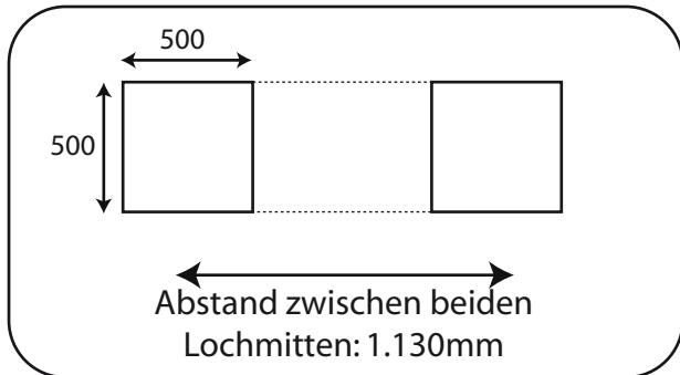
**1.** Bestimmen Sie zuerst, wo Ihre Überdachung aufgestellt werden sollte. Wir empfehlen Ihnen, Löcher mit den folgenden Maßen 500mm x 500mm x 550mm tief zu graben und wir in der Abbildung angezeigt zu positionieren.
