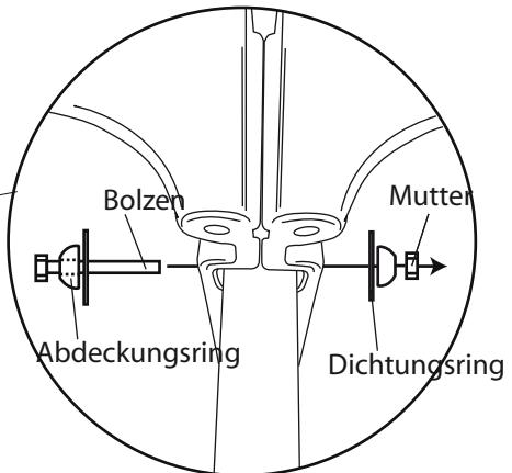
3. Platzieren Sie einen Bolzen durch einen Abdeckungsring und dann durch einen 50mm Dichtungsring und halten Sie ihn fest.
