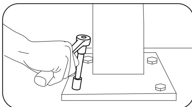
**5.** Mithilfe eines 17mm Drehmomentschlüssels ziehen Sie die 4 Fixierungen auf beiden Bodenplatten fest.
